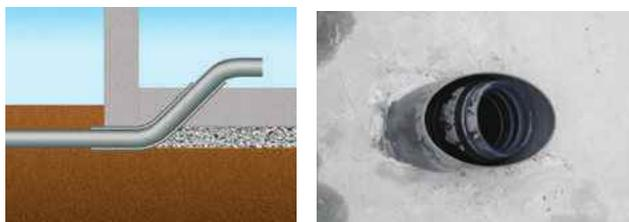
配管を二重にすることで、補修・交換を容易にした排水管の例
